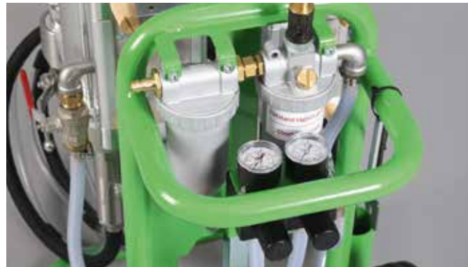
Drukregelaar en waterafscheider
