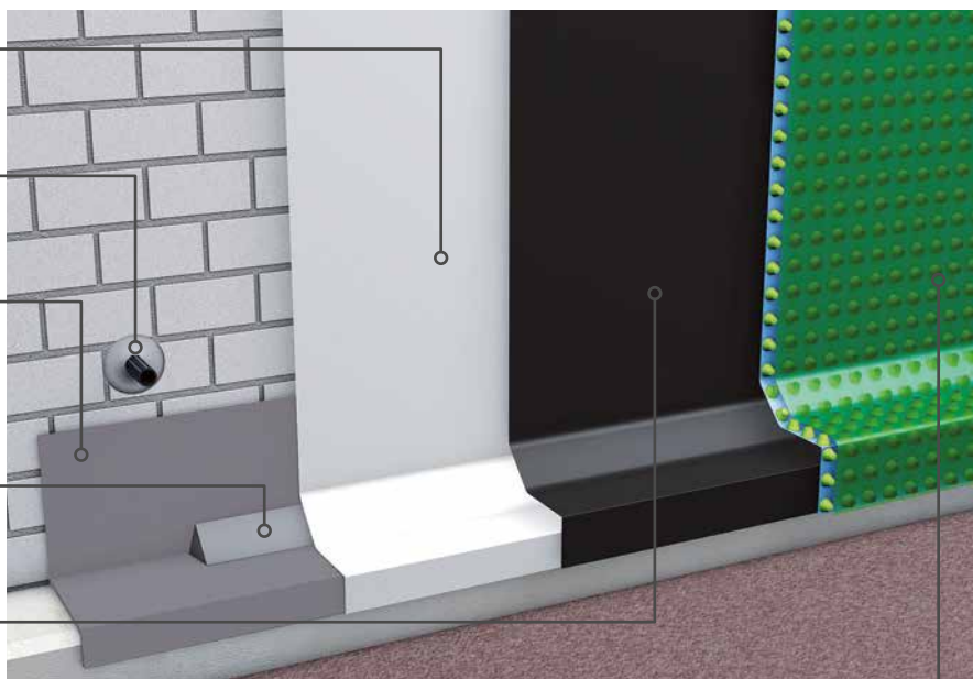
Systeemvoorbeeld: Afdichting volgens DIN EN 18 533
